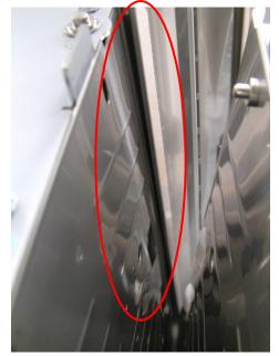
2. If the Lower entrance panel (PL #) is bent, Replace it (ARP #); If the Inner Entrance panel (PL #) is bent, Replace it (ARP #).
